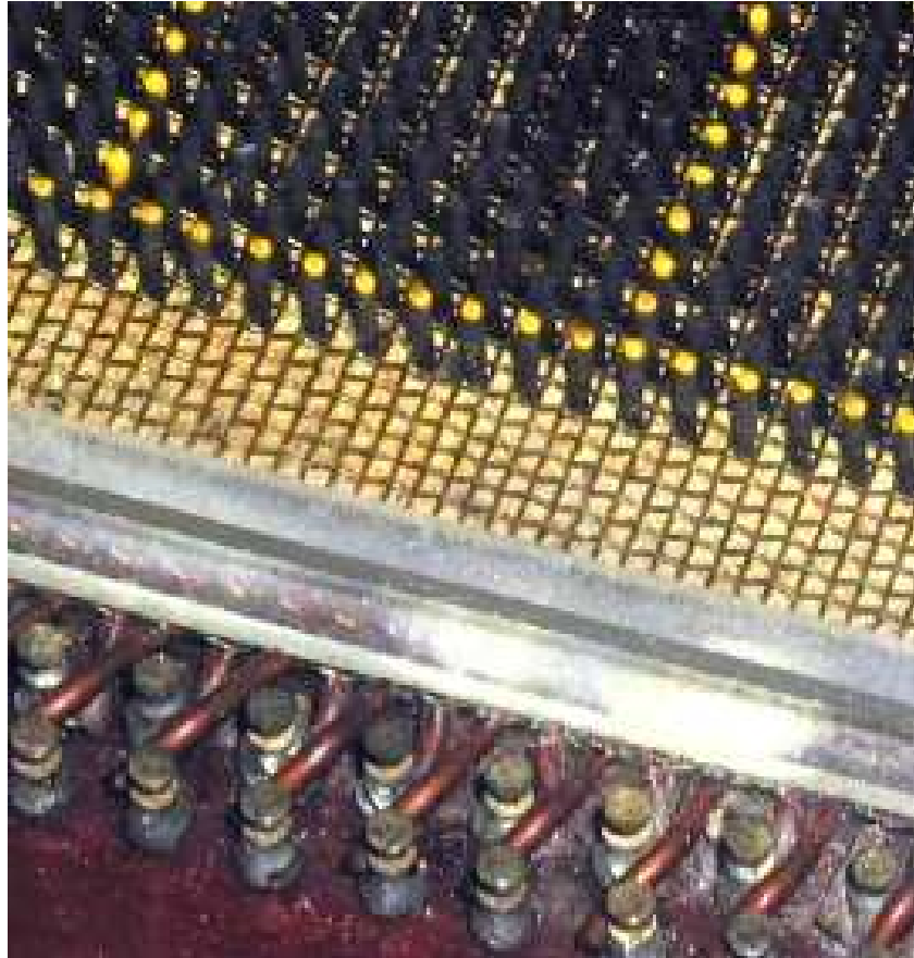
Figura 21- Il selettore dei segnali della CEP (1958-1960) – particolare.
