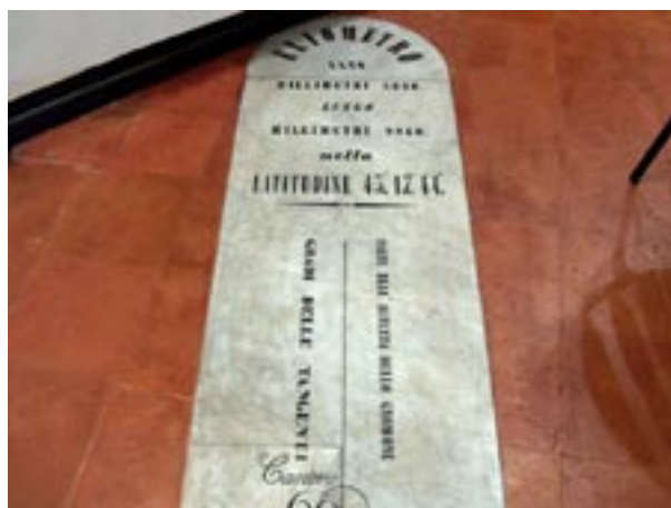
Figura 4 - Meridiana a camera oscura inserita nel pavimento dell'Aula Magna dell'Accademia, costruita nel 1848-1850.
