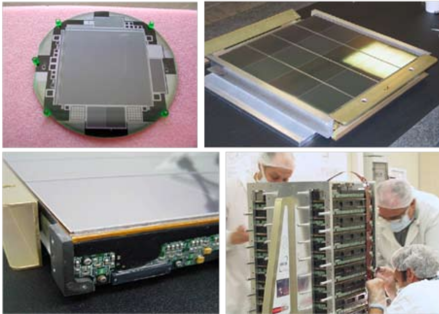
Figura 7. Componenti del tracciatore del LAT durante l'assemblaggio dei moduli. In alto a sinistra un singolo SSD, in alto a destra un Tray completo con i sensori visibili su un lato. In basso a sinistra un dettaglio di un Tray in cui è visibile la scheda elettronica di lettura. In basso a destra i Tray sono impilati nella torre e si stanno montando i cavi prima di chiudere i pannelli laterali.
